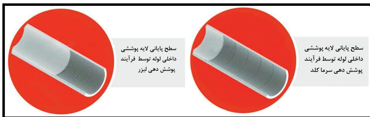
شکل ۳- مقایسه لایه پوششی ایجاد شده در دو فرآیند سرما کلد و لیزر
