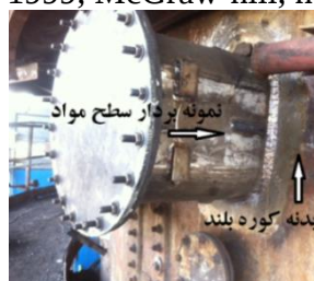
شکل ۱. فولاد زنگ نزن ۳۱۰ نمونه بردار بالایی سطح مواد به بدنه کوره بلند. شکل ۲. طرح اتصال مورد استفاده.
