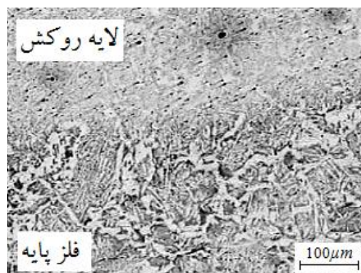
شکل ۲: ریز ساختار مربوط به فصل مشترک لایه روکش و فلز پایه
