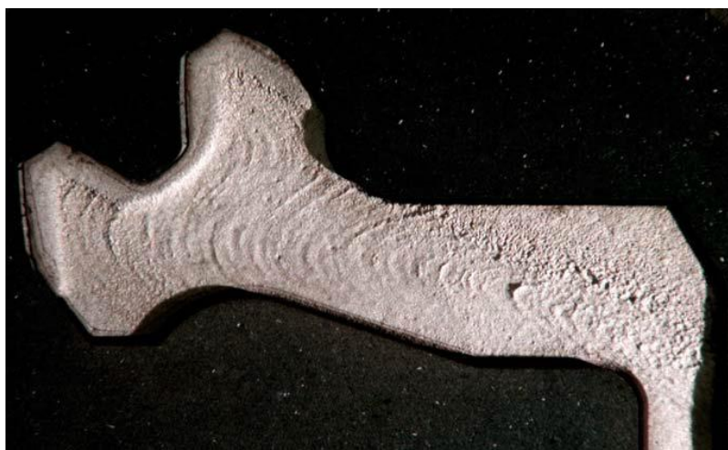
شکل ۲۹ جهت نامناسب خط شار نرمال به تنش بیشینه، اچ شده توسط HCl+H_2O_2
