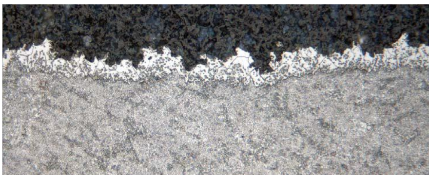
شکل ۳ حمله میان دانه ای در نیکل
