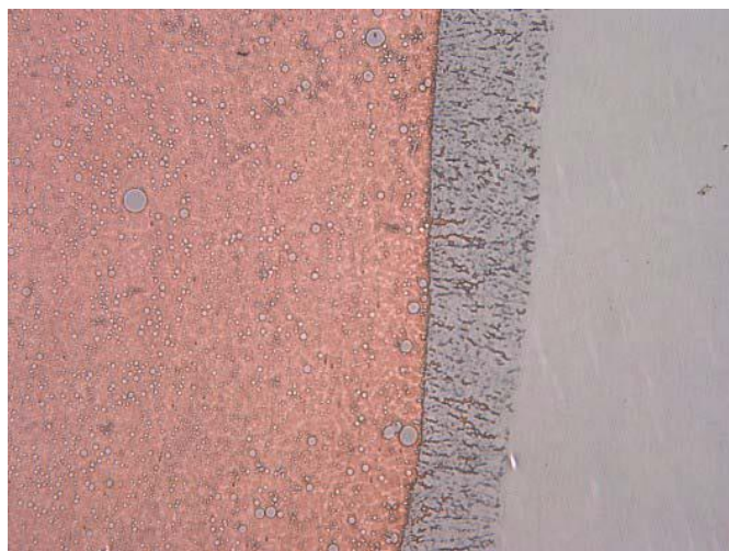
شکل ۱۰ جوش مس- فولاد زنگ نزن ( نفوذ فولاد زنگ نزن در مس)
