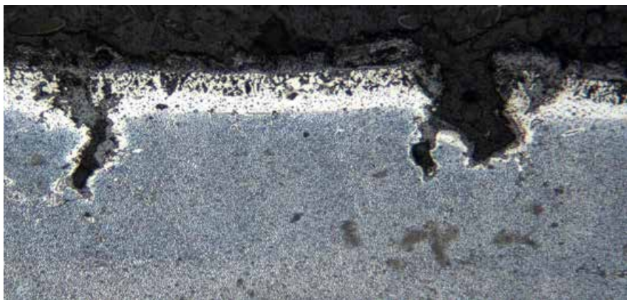
شکل ۲ خالی شدن آلیاژ میان دانه ای در نیکل
