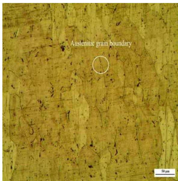
شکل (۱۲): ریزساختار فلز جوش اینکونل ۸۲ قبل از عملیات پیرسازی.
