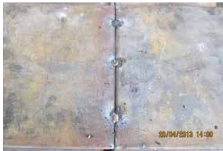
شکل (۲): اتصال ورق توسط ۳ خال جوش به یکدیگر
